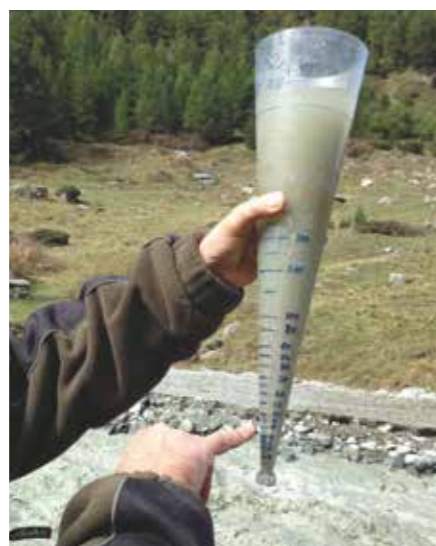
Les audits de purge des bassins – ici celui de Tourtemagne – ont été l'une des priorités de l'année du secteur environnement d'HYDRO Exploitation. Le taux des matières en suspension (MES) est une des mesures réalisées dans ce type d'audit.
