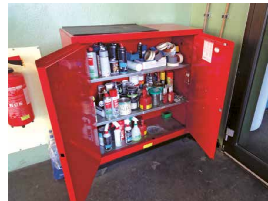
La directive relative à l'utilisation et au stockage des bouteilles de gaz a été révisée en 2021, et de nouvelles bonnes pratiques mises en place concernant les produits inflammables, à l'image de cette armoire de stockage (ci-dessus) et des bacs de rétention placés sous les fûts d'huile (en haut, à droite).
