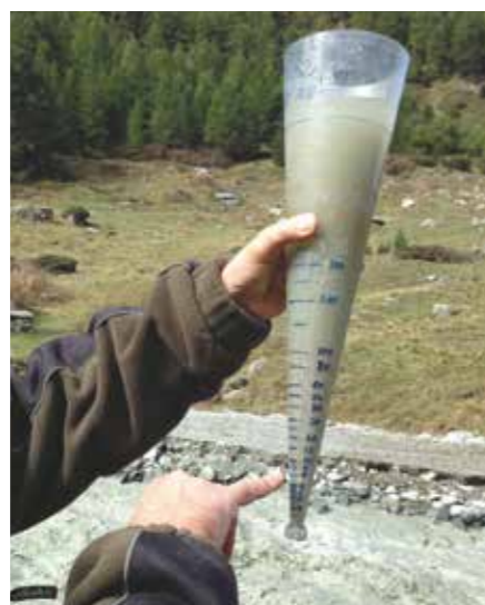
Die Audits der Beckenspülungen - hier der Turtmann-Staudamm - war in diesem Jahr eine der Prioritäten des Bereichs Umweltschutz bei HYDRO Exploitation. Der Anteil der Feststoffe (Schwebestoffkonzentration) ist eine der Messungen, die bei dieser Art von Audit durchgeführt werden.
